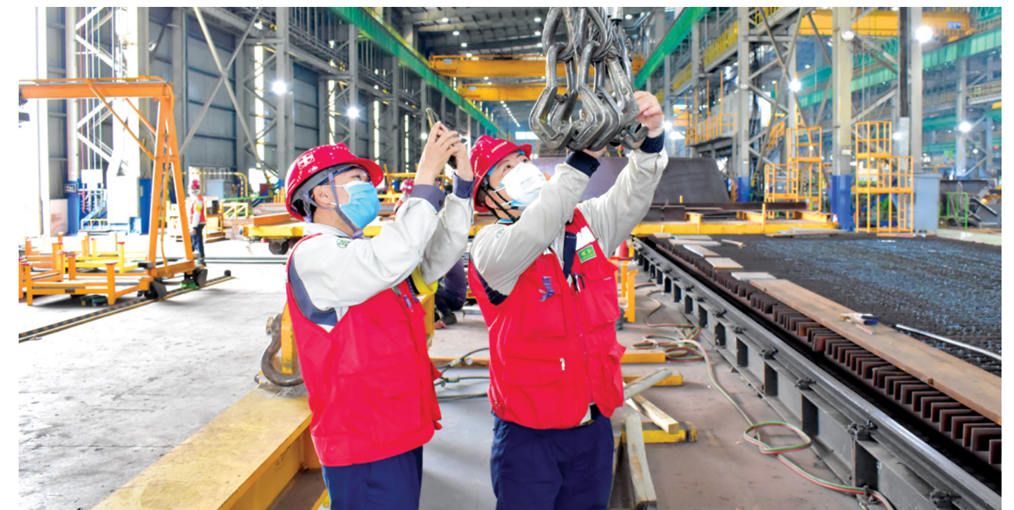
Safety staff check a crane before operation // Nhân viên an toàn kiểm tra thiết bị cấu trước khi tiến hành công việc
