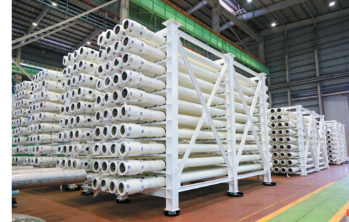
Shoaiba-4 project's first reverse osmosis desalination equipment manufactured for Saudi Arabia customer // Thiết bị Khử mặn thẩm thấu ngược đầu tiên của dự án Shoaiba-4 được sản xuất cho khách hàng Ả Rập Xê Út
