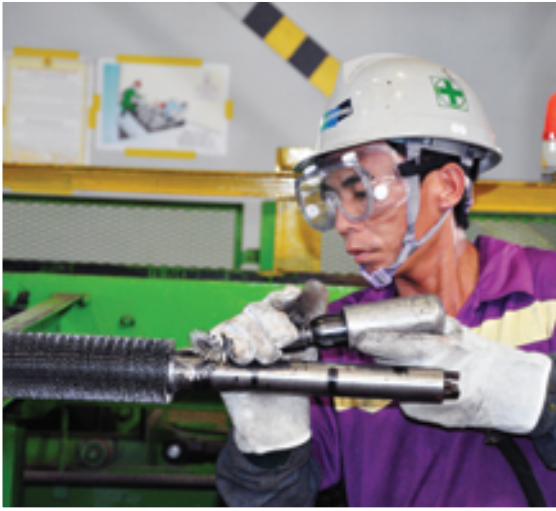
Manufacturing fin tubes n HRSG
