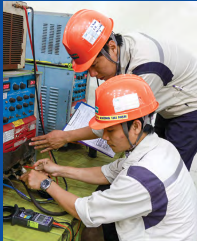
Kiểm tra dòng điện hàn để chắc chắn nó phù hợp với các yêu cầu của WPS
